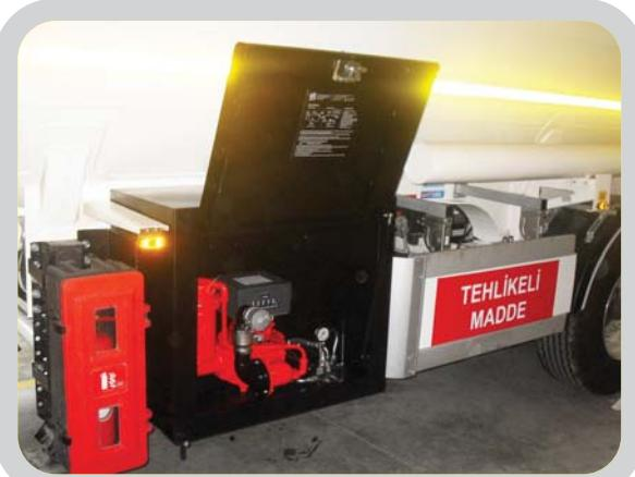
Yan muhafaza kesilerek sayaç dolabı için yer açılır. Dolap, statik ve dinamik olarak yükle dayanıklı olacak şekilde tasarımılmış ve bilgisayar testi yapılmıştır.
