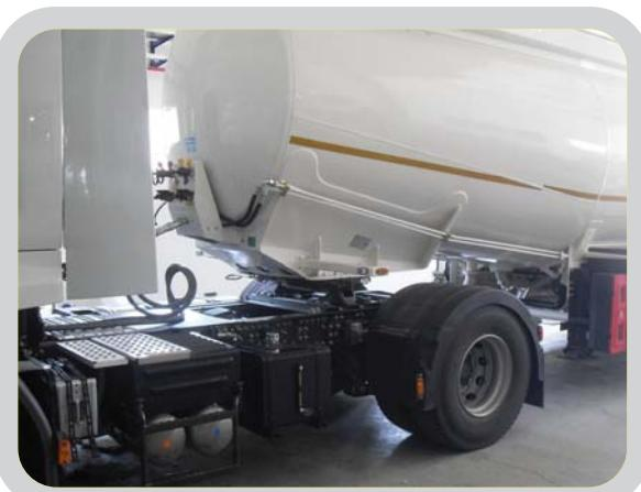
Çekici üzerindeki yağ pompası, hidrolik gücü dorse yanına akuple edilen hidrolik borular vasıtası ile gönderir.
