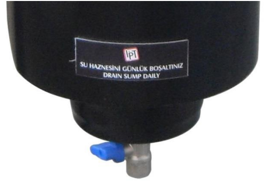
Şekil 5. Su boşaltım vanası
