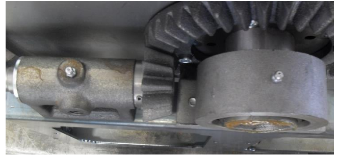
Şekil 15. Yatak ve çevirme kolu bağlantısı üzeri gresörlükler
