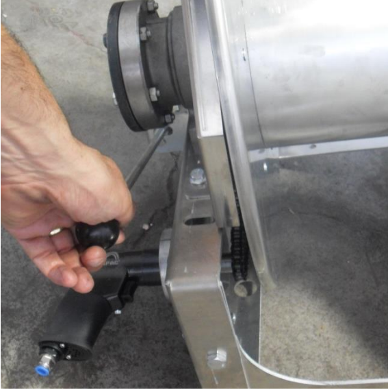
Şekil 8. Motor tahrikli makarada debriyaj kolu
